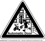
WARNUNG: Automatisches Tor - Nicht im Bewegungsbereich des Tores aufhalten, da sich das Tor unerwartet in Bewegung setzen kann. WARNING: Automatic door - The door may operate unexpectedly. Therefore do not allow anything/persons to stay in the path of the door.
