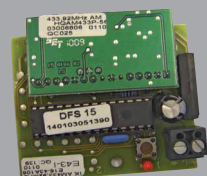
Récepteur pour commande à distance (également disponible en boîtier)
